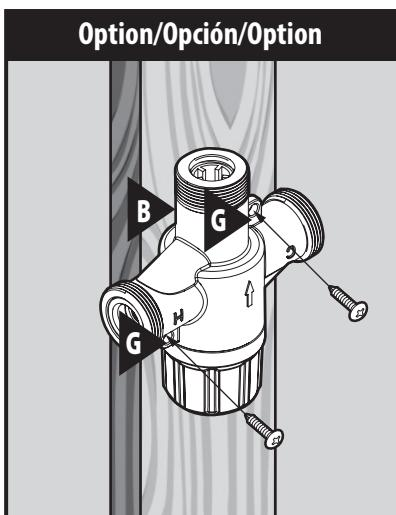
Para fijar la válvula (B) para mayor facilidad de instalación, inserte los tornillos a través de las aletas de montaje (G) y móntela en un 2x4 u otra superficie disponible.
